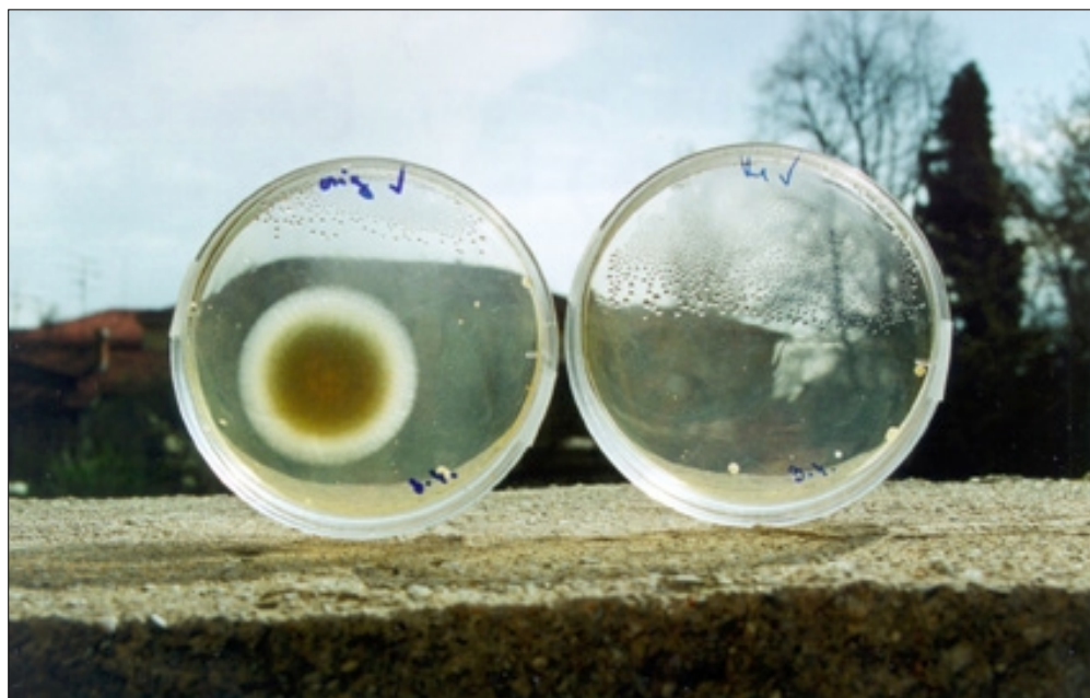
V levi petrijevki na gornji sliki so bakterije iz vode, ki je bila v navadnem kozarcu. V desni petrijevki, v njej je bila voda iz Kozarca 2000, pa je bakterij za 25 odstotkov manj. Na spodnji sliki je levo petrijevka s plesnijo iz vode iz navadnega kozarca, v desni, v kateri je bila voda iz Kozarca 2000, se plesen ni razvila.
